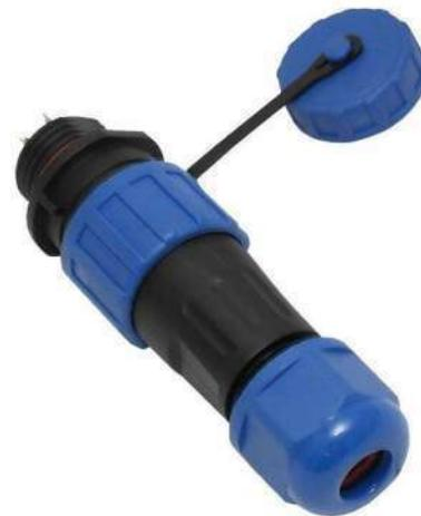
Герметичный разъем серии SP-16 представляет собой комплект, состоящий из гнезда «мама» (розетка) и штекера «папа» (вилка), которые соединяются друг с другом по принципу штепсельного соединения, дополнительно фиксируемого и герметизируемого пластиковой гайкой. Коннектор «мама» также всегда комплектуется защитной крышкой, которую можно использовать, чтобы защитить внутренности гнезда от пыли и влаги, когда оно остается без соединения со штекером.
